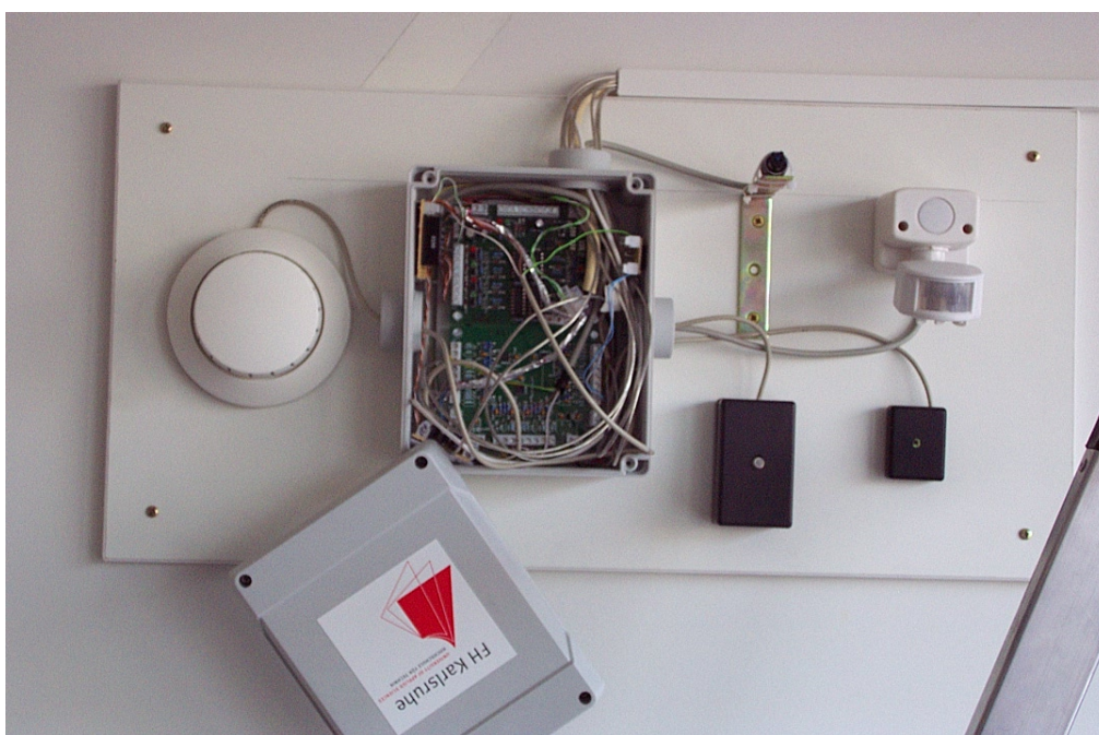
Abb. 1: Werkstoffplatte mit Sensoren, Mess- und Steuerungsmodulen
