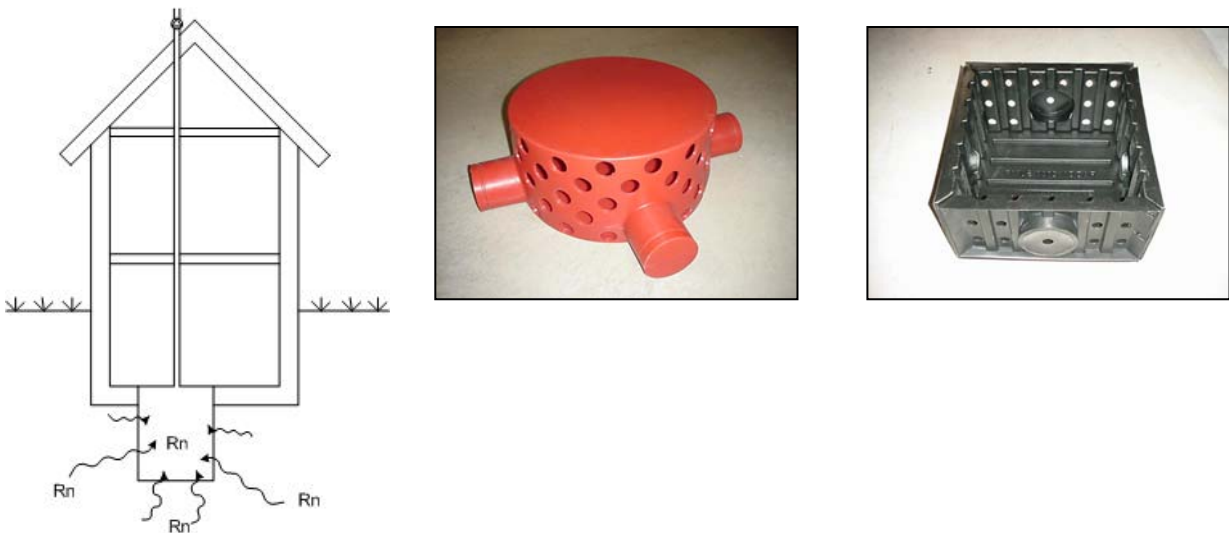
Abb. 1.4: Boden entlüften mit einem Radonbrunnen oder Drainagesystem (je nach Situation aktiv oder passiv)
