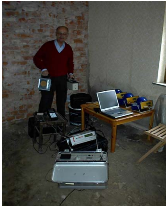
Abb. 1: Erfassung der Radonkonzentration vor Baubeginn
